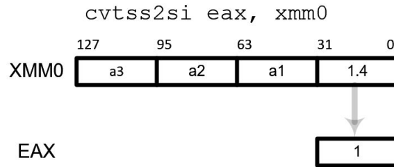
Figure 17: Konverzija realnog broja jednostruke preciznosti (tip float) sa najnižih bitova registra xmm0 na najbliži ceo broj koji se potom upisuje u eax
